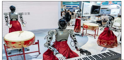
Una banda de robots de LinkerBot toca música tradicional china. Su mano puede alcanzar 42° de libertad de movimiento y su muñeca rotar en 360°.
