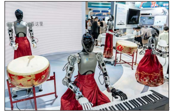
Una banda de robots de LinkerBot toca música tradicional china. Su mano puede alcanzar 42° de libertad de movimiento y su muñeca rotar en 360°.
